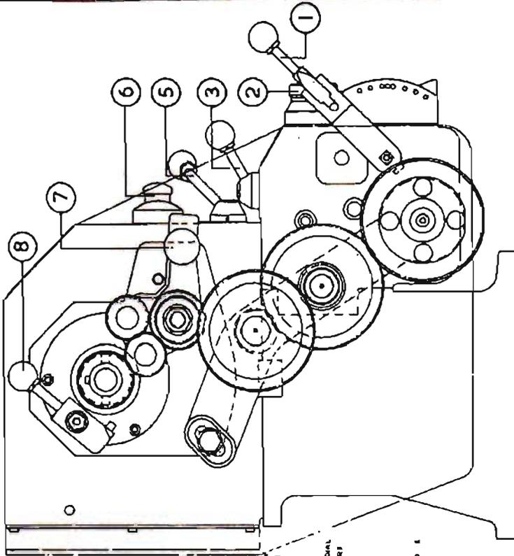
(A) FOR THE SELECTION OF SPINDLE SPEEDS REQUIRED SET CHART ON HEADSTOCK. MOVE V-BELT LOCATED INSIDE CHART TO THE POSITION REQUIRED THEN MOVE BACK GEAR LEVER (ITEM 5) TO EITHER L OR R POSITION REFERRED ON SPEEDS CHART. WARNING: STATE THE LATHE IS NOT RUNNING whilst CHANGING GEAR.
